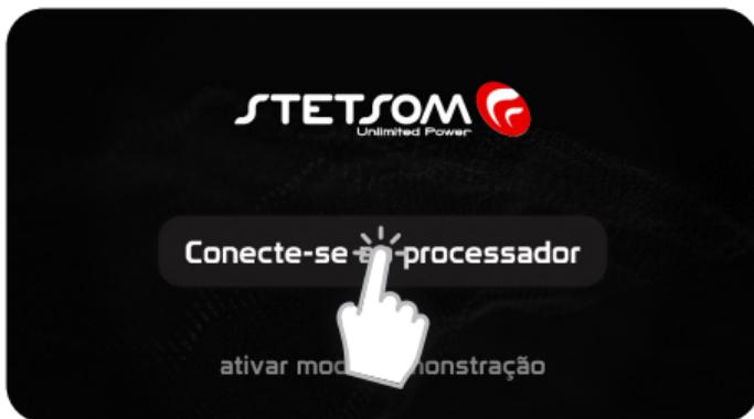
O **modo demonstração** permite o uso do aplicativo sem conexão com processador (algumas funções estarão indisponíveis neste modo).
