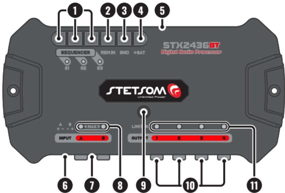
**1. SEQUENCER:** Este recurso permite o acionamento sequenciado de outros produtos através de sua conexão de acionamento remoto (REM). Faça a conexão utilizando um cabo de no mínimo **0,75mm<sup>2</sup>**. Cada conexão pode ser configurada, habilitada ou desabilitada pelo aplicativo ou controle SMC.
